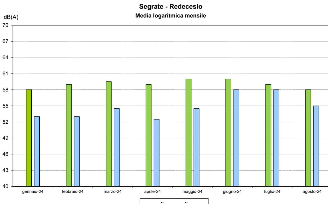
Indici acustici calcolati tramite correlazioni automatiche attuate rispetto ai tracciati radar, con esclusione degli eventi non aeronautici più rilevanti.
