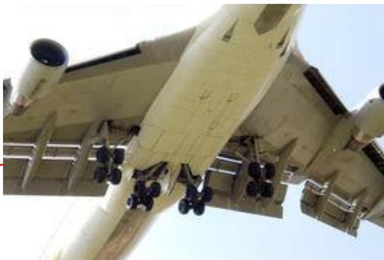
Durante le operazioni sottobordo, è necessario porre attenzione ai **flap** estesi, ai **portelli** dell'alloggiamento dei carrelli, ai sistemi per le operazioni di pulizia delle toilette e rifornimento acqua.
